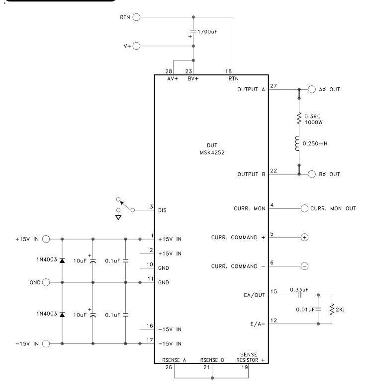
TYPICAL TEST SCHEMATIC
